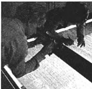
Перенос компоновочного чертежа на рубилит
